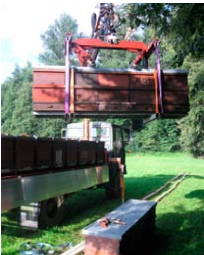
Fot. 4, 5, 6. Załadunek uli za pomocą hydraulicznego dźwigu samochodowego
