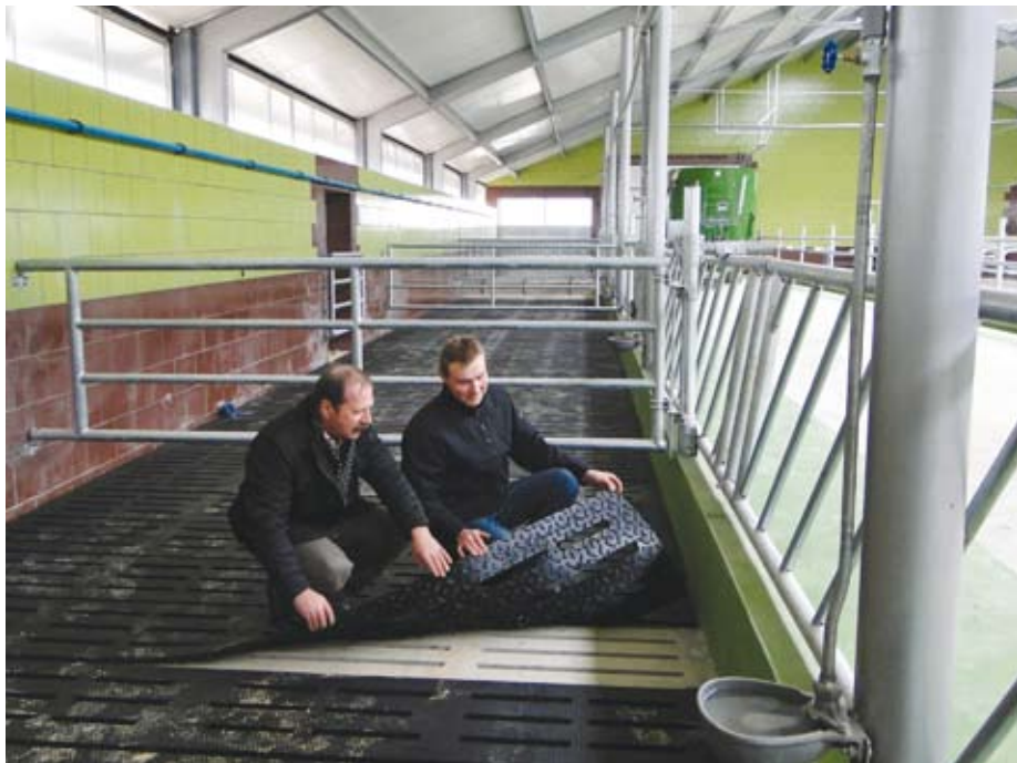
Prezentacja nakładek gumowych na rusztach betonowych
